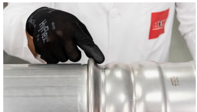
Figura 36 - Controllo visivo pressatura Oversize
